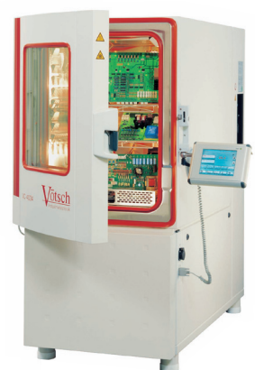
Prüflinge in der Voetsch-Klimakammer
